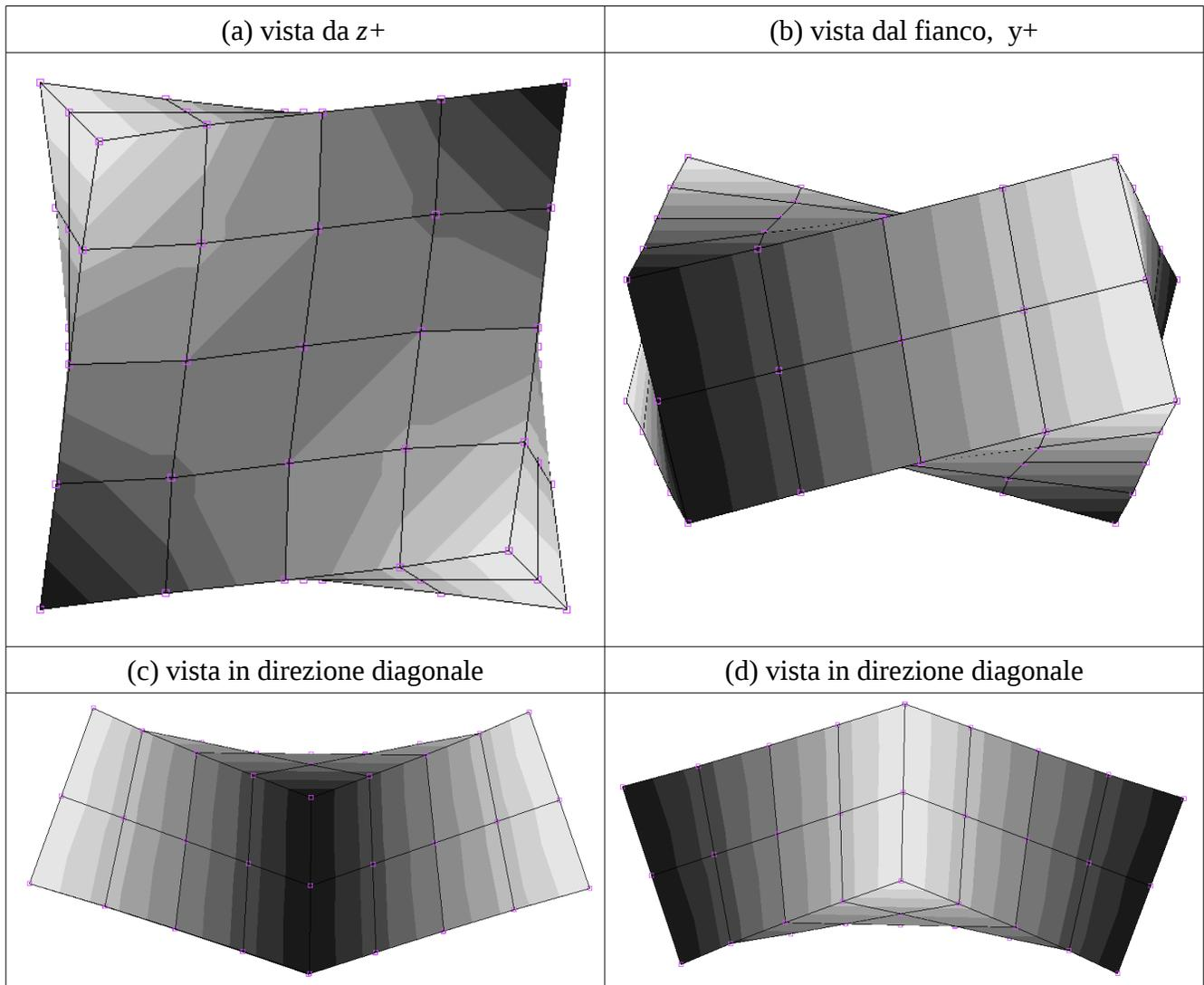
Componente “torsionale”  $\kappa_{xy}$  di curvatura. In (a) viene mostrata l'opposta deformazione tagliante caratterizzante le superfici superiore e inferiore della piastra; in (b) viene giustificata la caratterizzazione torsionale di tale deformazione, mentre in (c) e (d) viene evidenziata l'equivalenza della stessa ad uno stato di flessione biassiale con curvature anticlastiche lungo le diagonali del concio (deformata a sella).
