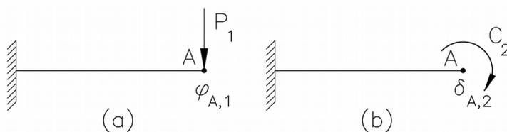
Si considera la trave incastrata di Figura (a), caricata all'estremità A da una forza trasversale  $P_1=20$  N, la cui rotazione in estremità  $\varphi_{A,1}$  risulta essere 0.15 radianti. Si considera poi la struttura ausiliaria di Figura (b), caricata all'estremità A da una coppia  $C_2$ , la cui freccia di estremità  $\delta_{A,2}$  risulta essere 2.5 mm. Si calcoli con il teorema di Betti il valore della coppia  $C_2$ .
