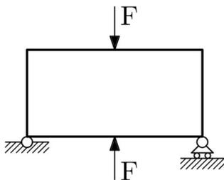
Proporre una deformata qualitativa per il telaio rettangolare di figura, simmetricamente caricato da forze uguali e opposte. Si notino
