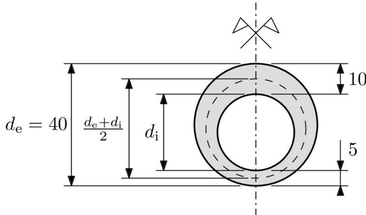
Considerare la sezione circolare cava con foro circolare eccentrico di figura, con diametro esterno 40 mm e spessore di parete variabile da un minimo di 5 mm ad un massimo di 10 mm.
