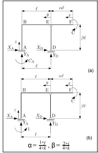
Considerare la struttura staticamente indeterminata di figura (a), caricata dalla coppia concentrata C.
