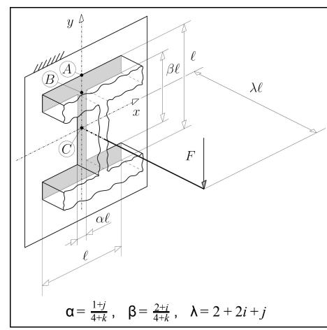
Si consideri la struttura trabeiforme in figura, incastrata ad un estremo e caricata da una forza concentrata all'altro, e costituita da un profilato a sezione ad "I".
