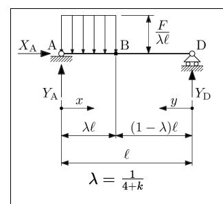
Considerare la trave incernierata/appoggiata di figura, caricata su una sua porzione AB da un carico distribuito uniforme di risultante F. Calcolare le componenti di reazione vincolare
