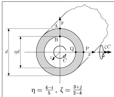
Considerare la trave a sezione circolare cava di figura, soggetta ad un momento torcente di entità C, e ad un momento flettente di entità  $\zeta C$ , con asse momento allineato ad x. Calcolare le componenti di tensione assiale e tangenziale ai punti A, B, P e Q.
