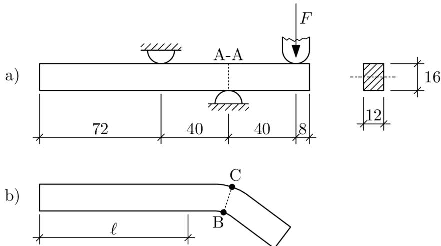
Si consideri la barra a sezione rettangolare in figura a), realizzata in acciaio duttile con tensione di snervamento pari a 240 MPa, da piegarsi in corrispondenza della sezione "A-A" in modo da ottenere il manufatto rappresentato in figura b). Tale operazione viene effettuata mediante il dispositivo a tre appoggi (due fissi e uno mobile) rappresentato in figura a).
