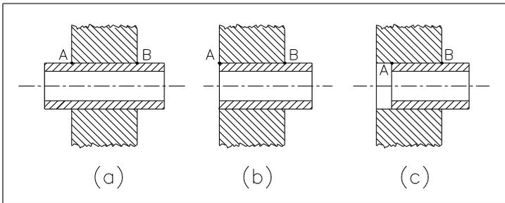
**3** Si consideri il forzamento di uno spinotto cavo deformabile in una piastra forata rigida. Si disegni l'andamento qualitativo della pressione di contatto tra i punti A e B per le tre situazioni (a), (b), (c).
